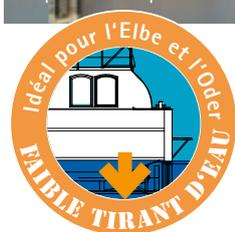
Kormoran et Aquino sont parfaitement adaptés aux croisières sur l'Elbe ou l'Oder sans écluses. Grâce à leur faible tirant d'eau, ces bateaux à carène s'accommodent également des faibles niveaux d'eau. L'hélice et le gouvernail sont protégés des chocs avec le fond par un cadre en acier.
